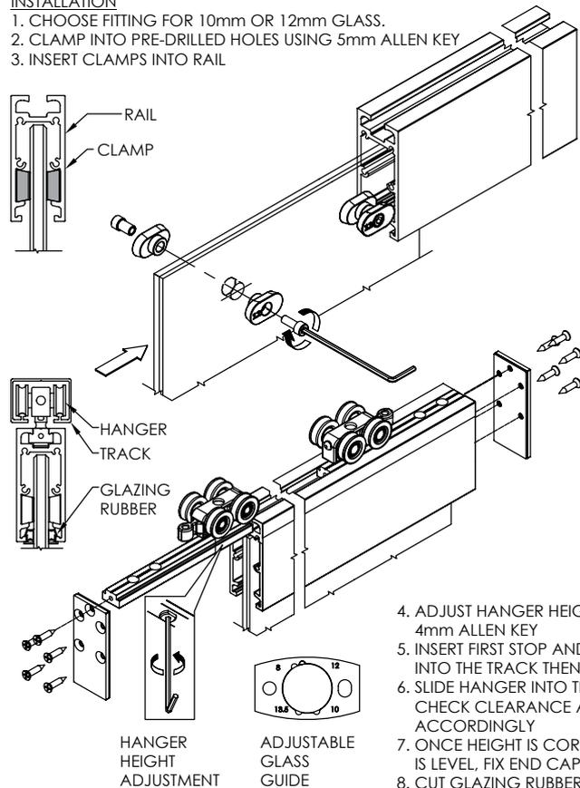
4. ADJUST HANGER HEIGHT USING 4mm ALLEN KEY
